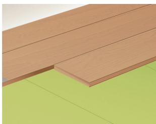
Installieren Sie Green Silence im kompletten Raum auf diese Art und Weise und verlegen Sie den Fußboden mit seiner langen Seite im 90° Winkel zu den Stößen der Dämmunterlage, direkt über Green Silence.
